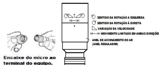
Encaixe do micro ao terminal do equipo.
