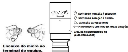
Encaixe do micro ao terminal do equipo.
