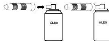
A lubrificação deve ser feita aplicando-se óleo spray pelo orifício da peça de mão conforme figura 08. Mantenha o tubo na posição vertical e aplique o óleo por 01 ou 02 segundos na entrada de ar da Peça de Mão;
